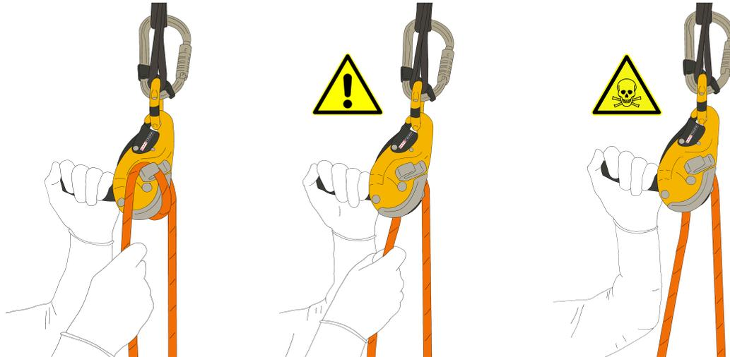
⚠ Die Ablassgeschwindigkeit wird über die Bremskraft an der Bremsnocke, der Bremsplatte und dem zusätzlichen Bremsselement gesteuert. Der Ablasshebel wird dabei bis zum Schleifpunkt geöffnet. Merksatz: *Die Hand am Seil ist das Gaspedal, die Hand am Hebel sucht den Schleifpunkt der Kupplung.*
