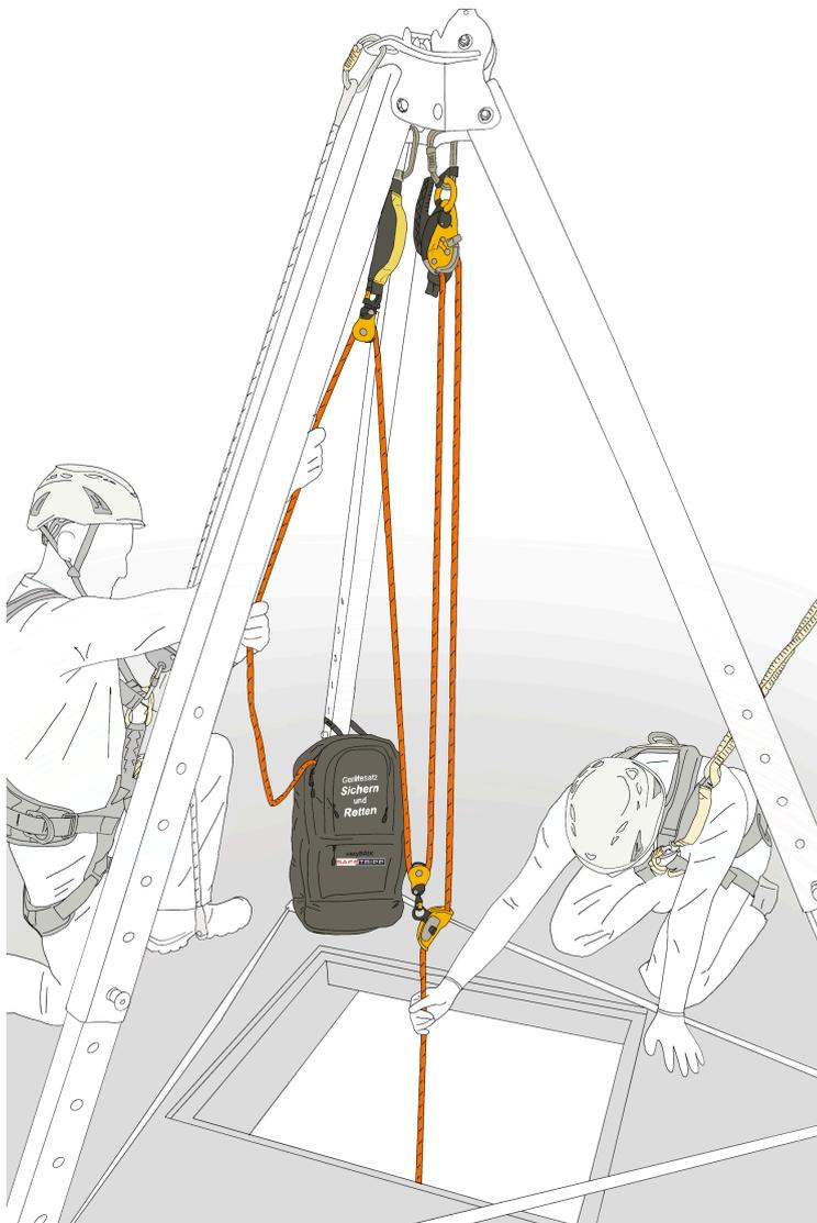
**!** Bei der Benutzung von künstlichen hohen Anschlagpunkten (Dreibein, Bockleiter etc.) muss besonders auf die Stabilität und auftretende Vektorkräfte geachtet werden, da letztere schnell zu einem Umstürzen führen können.
